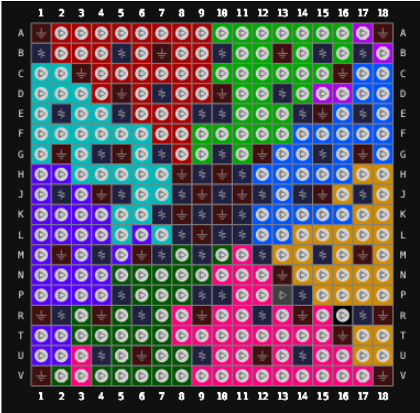
图 3-2 GW5A-25 器件 UG324S 封装管脚分布示意图（顶视图）
