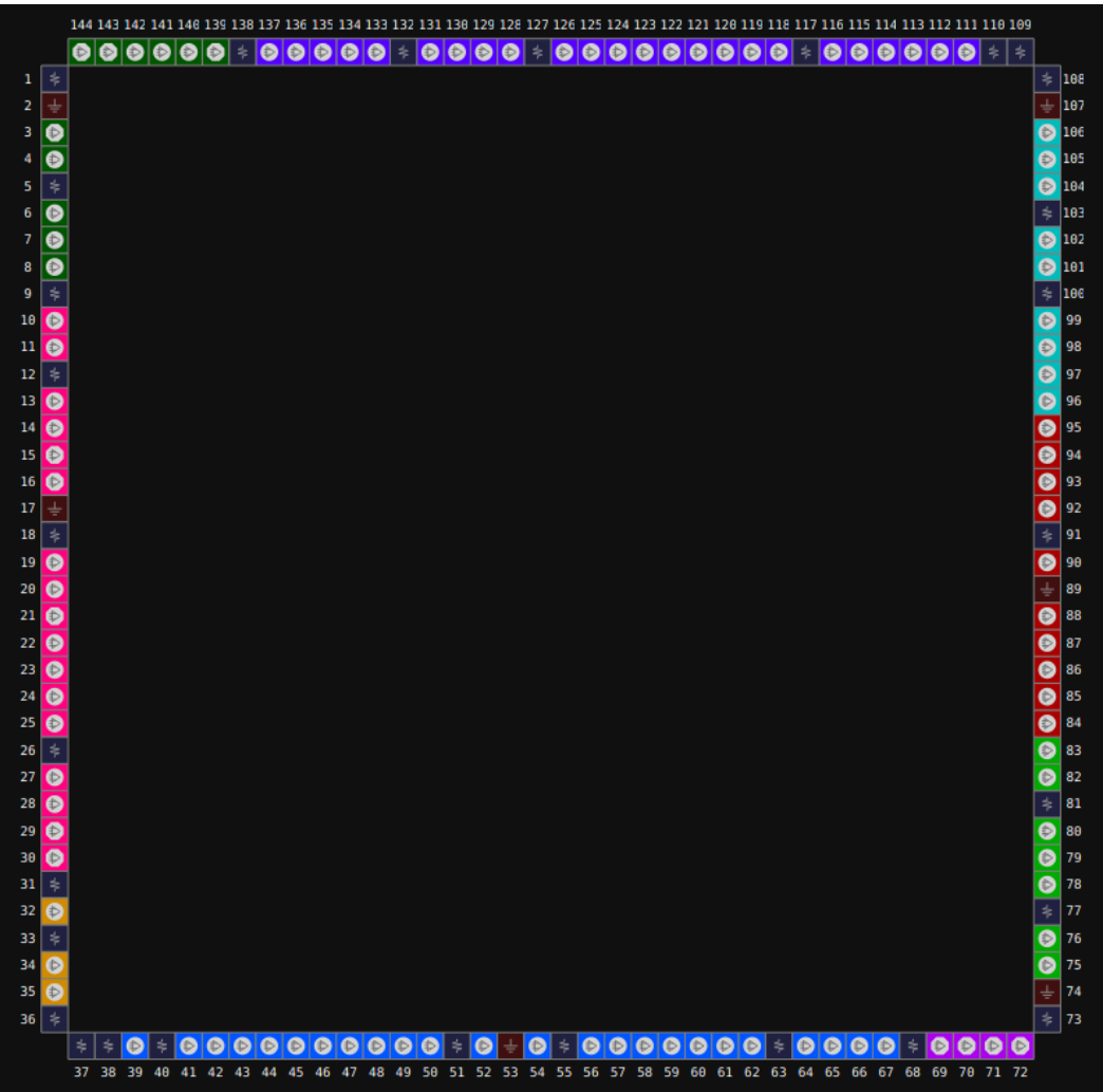
图 3-13 GW5A-25 器件 LQ144 EV 版本封装管脚分布示意图（顶视图）
