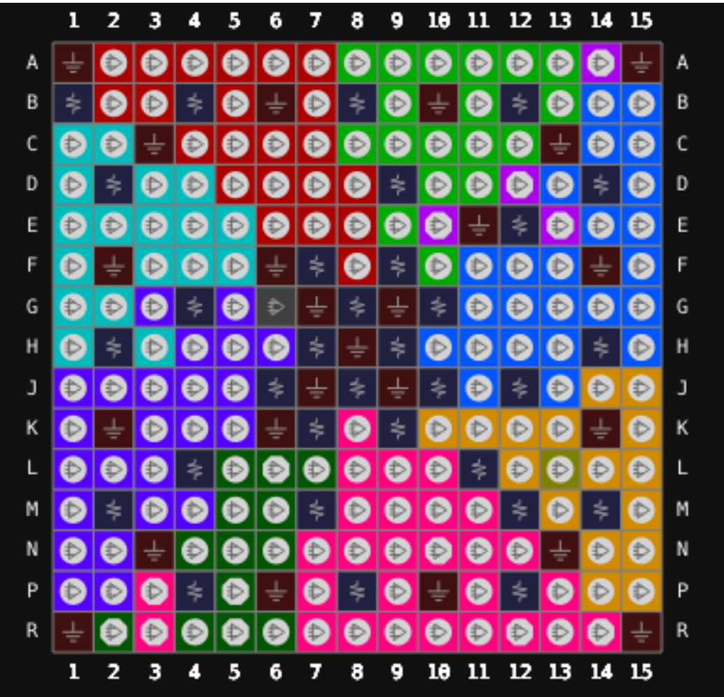
图 3-8 GW5A-25 器件 UG225S EV 版本封装管脚分布示意图（顶视图）
