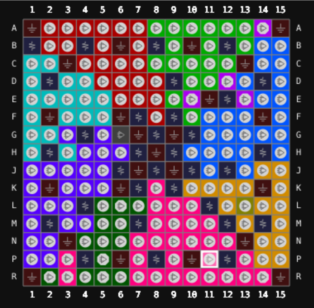
图 3-9 GW5A-25 器件 UG225S LV 版本封装管脚分布示意图（顶视图）
