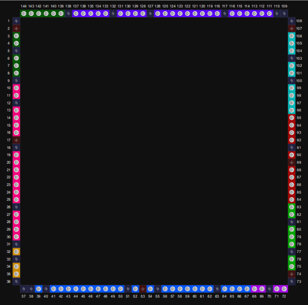
图 3-14 GW5A-25 器件 LQ144 LV 版本封装管脚分布示意图（顶视图）
