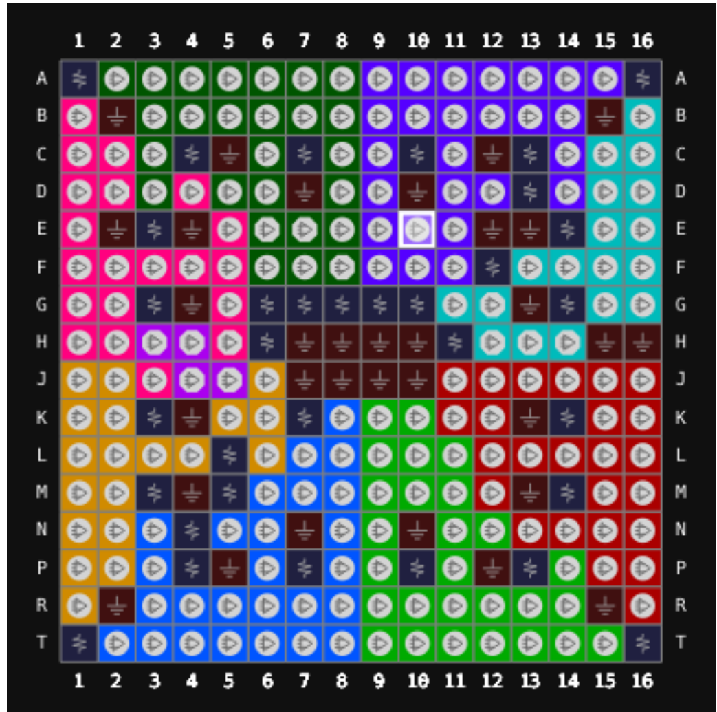
图 3-4 GW5A-25 器件 PG256C EV 版本封装管脚分布示意图（顶视图）
