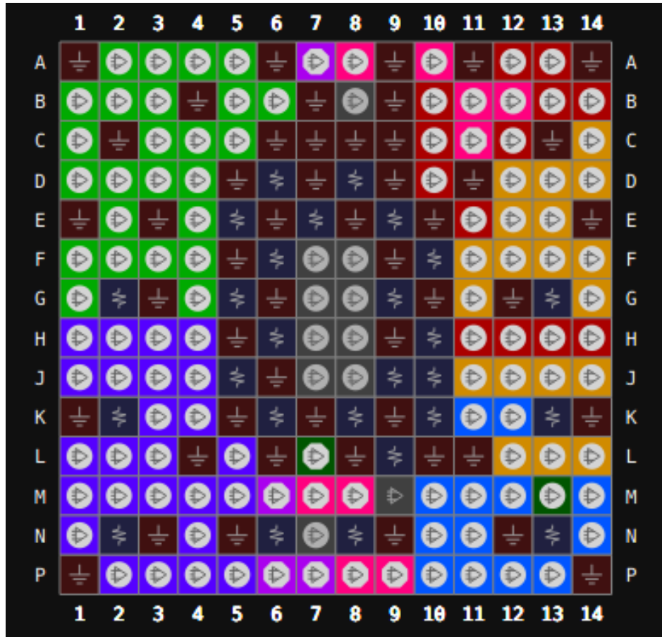
图 3-15 GW5A-25 器件 PG196S LV 版本封装管脚分布示意图（顶视图）
