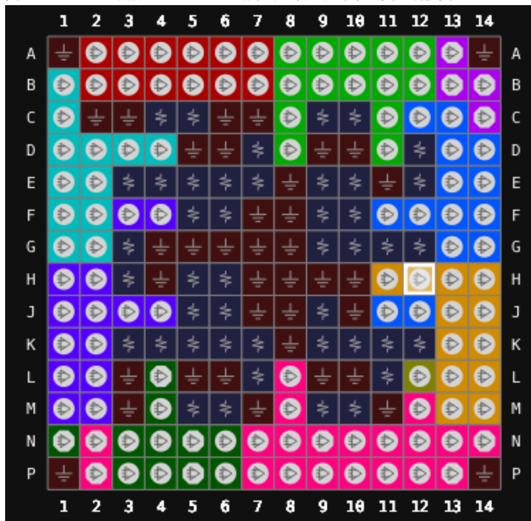
图 3-6 GW5A-25 器件 MG196S EV 版本封装管脚分布示意图（顶视图）
