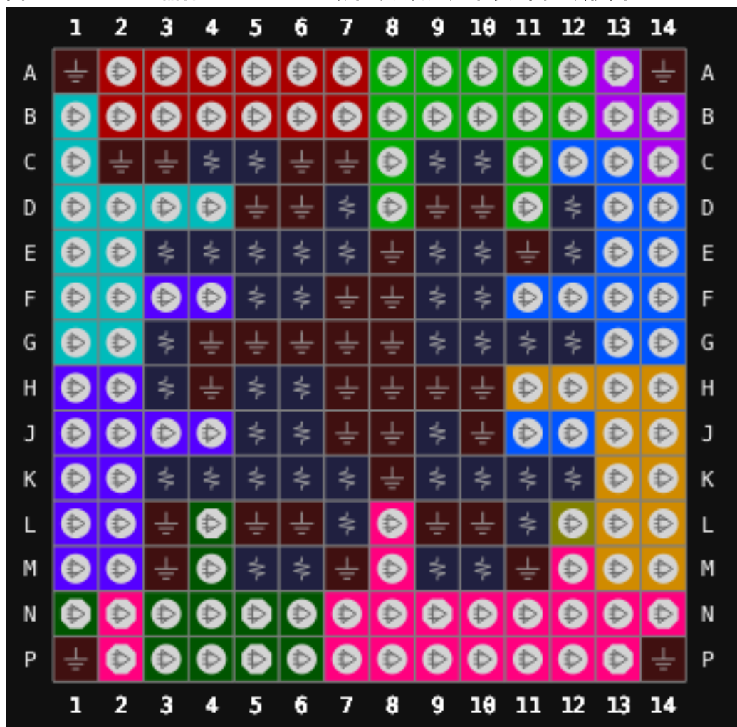
图 3-7 GW5A-25 器件 MG196S LV 版本封装管脚分布示意图（顶视图）
