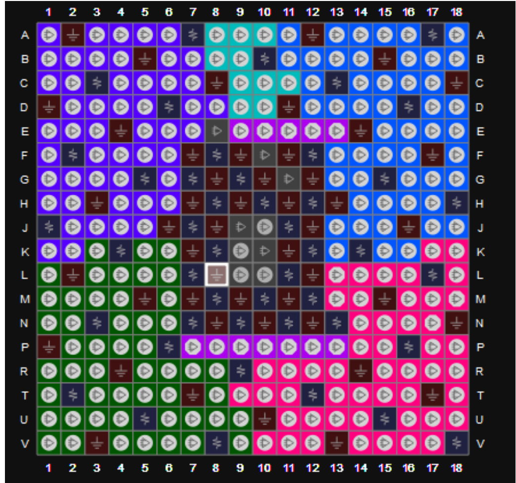
图 3-17 GW5A-138 器件 UG324A 封装管脚分布示意图（顶视图）
