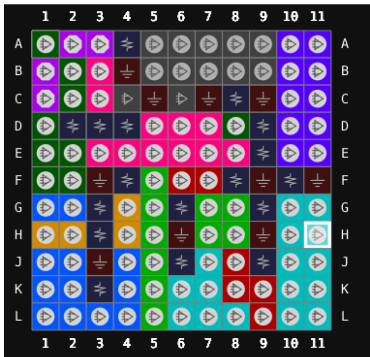
图 3-1 GW5A-25 器件 MG121N 封装管脚分布示意图（顶视图）
