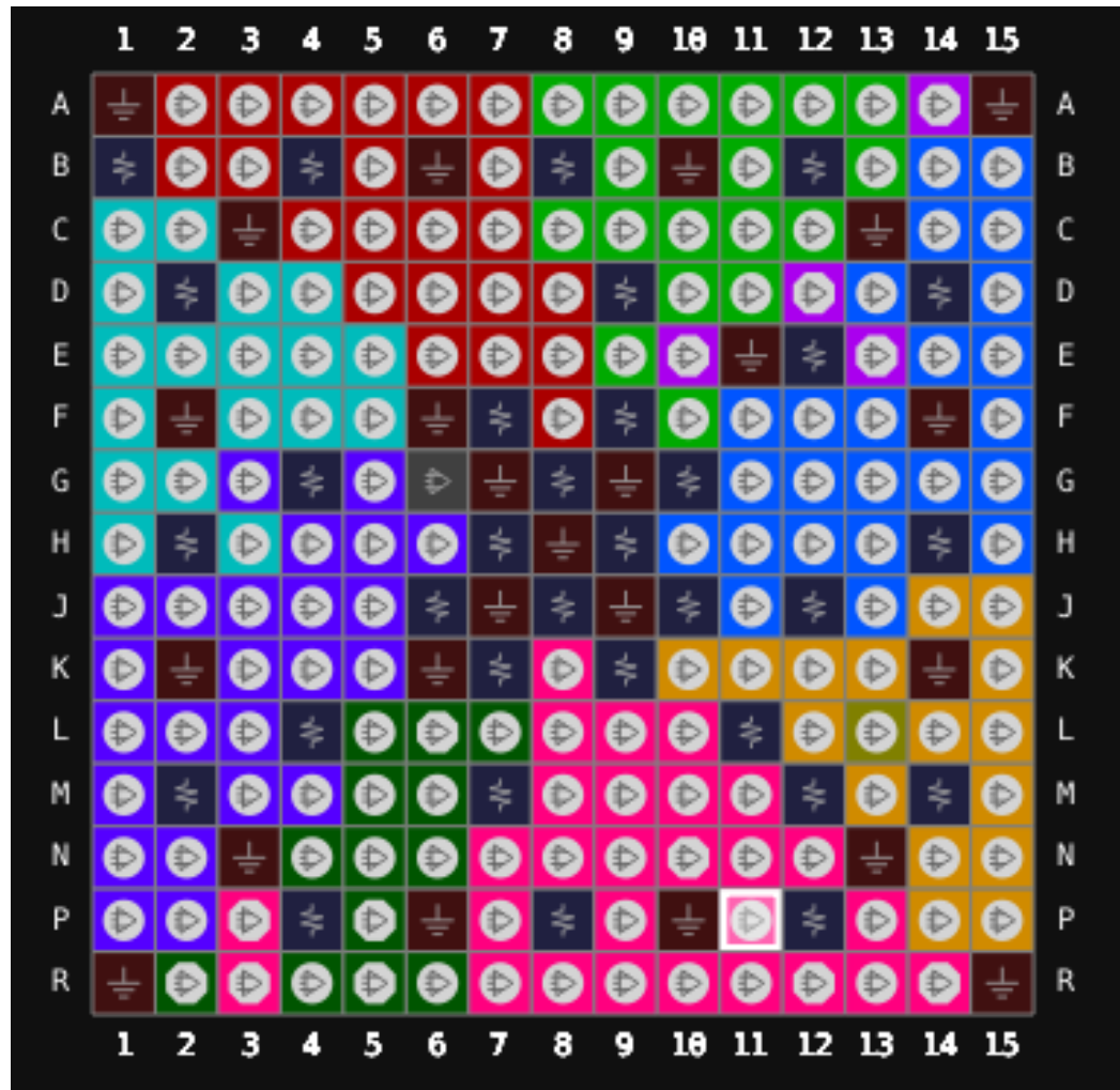
图 3-9 GW5A-25 器件 UG225S LV 版本封装管脚分布示意图（顶视图）
