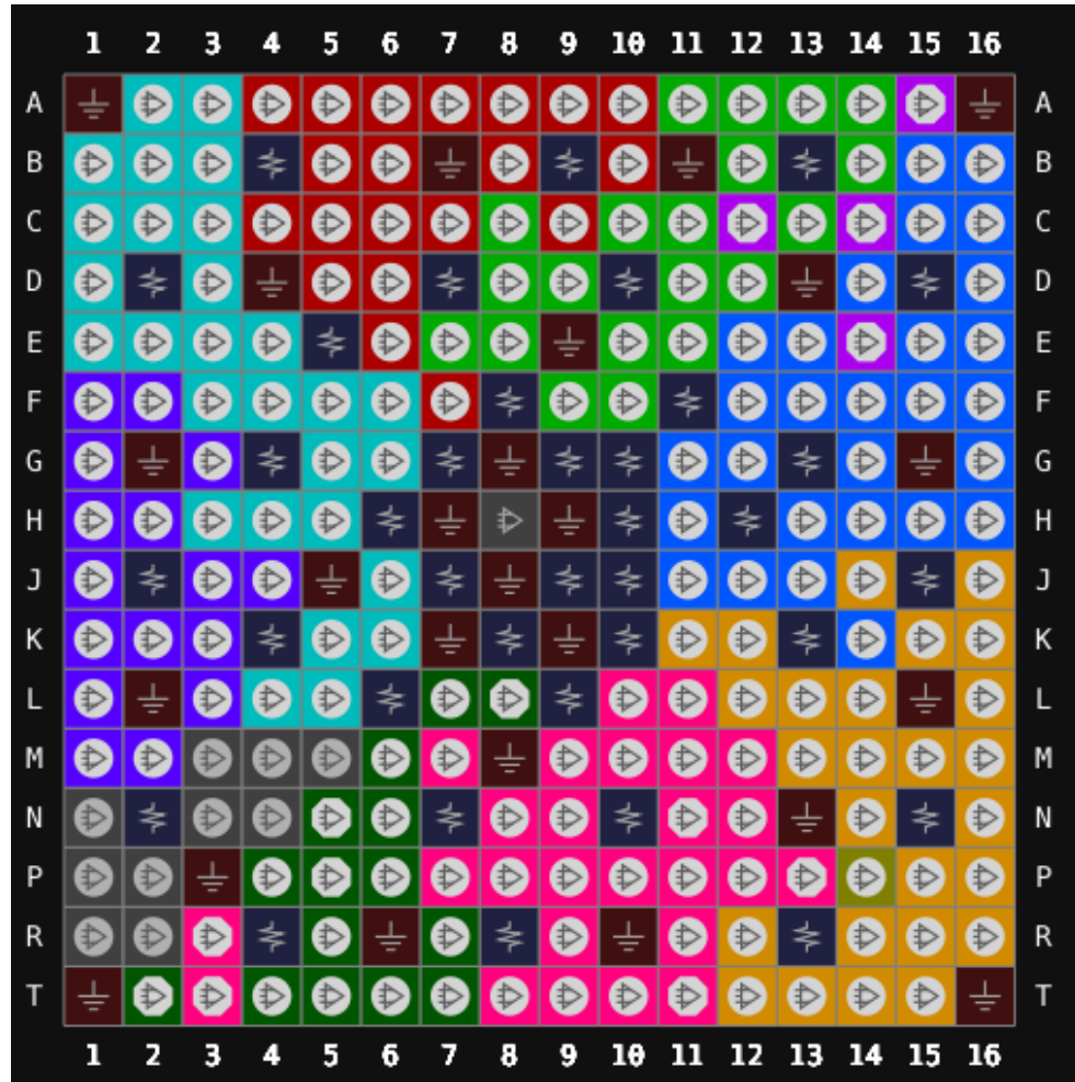
图 3-13 GW5A-25 器件 PG256 LV 版本封装管脚分布示意图（顶视图）
