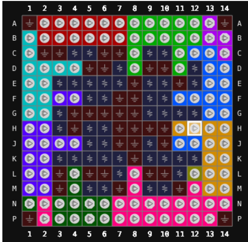
图 3-7 GW5A-25 器件 MG196S EV 版本封装管脚分布示意图（顶视图）
