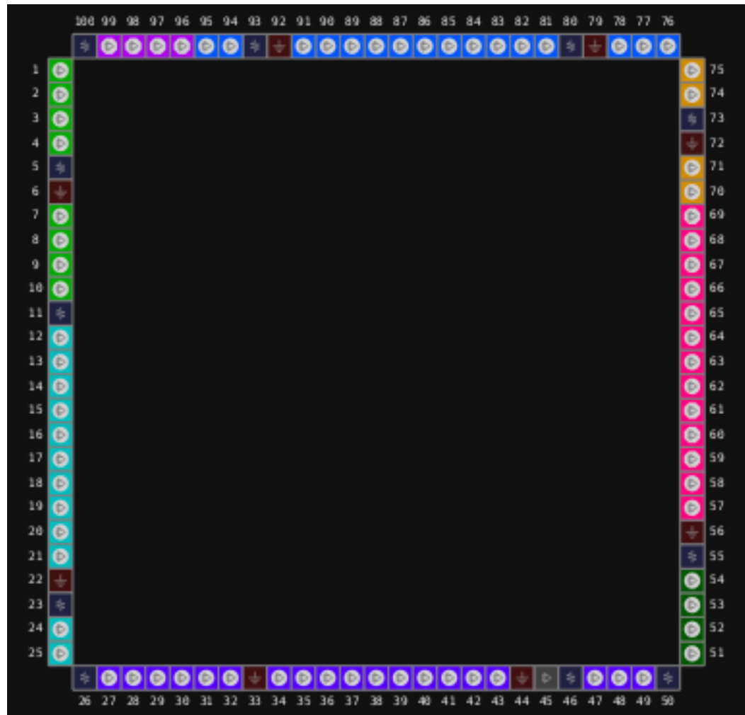
图 3-10 GW5A-25 器件 LQ100 EV 版本封装管脚分布示意图（顶视图）
