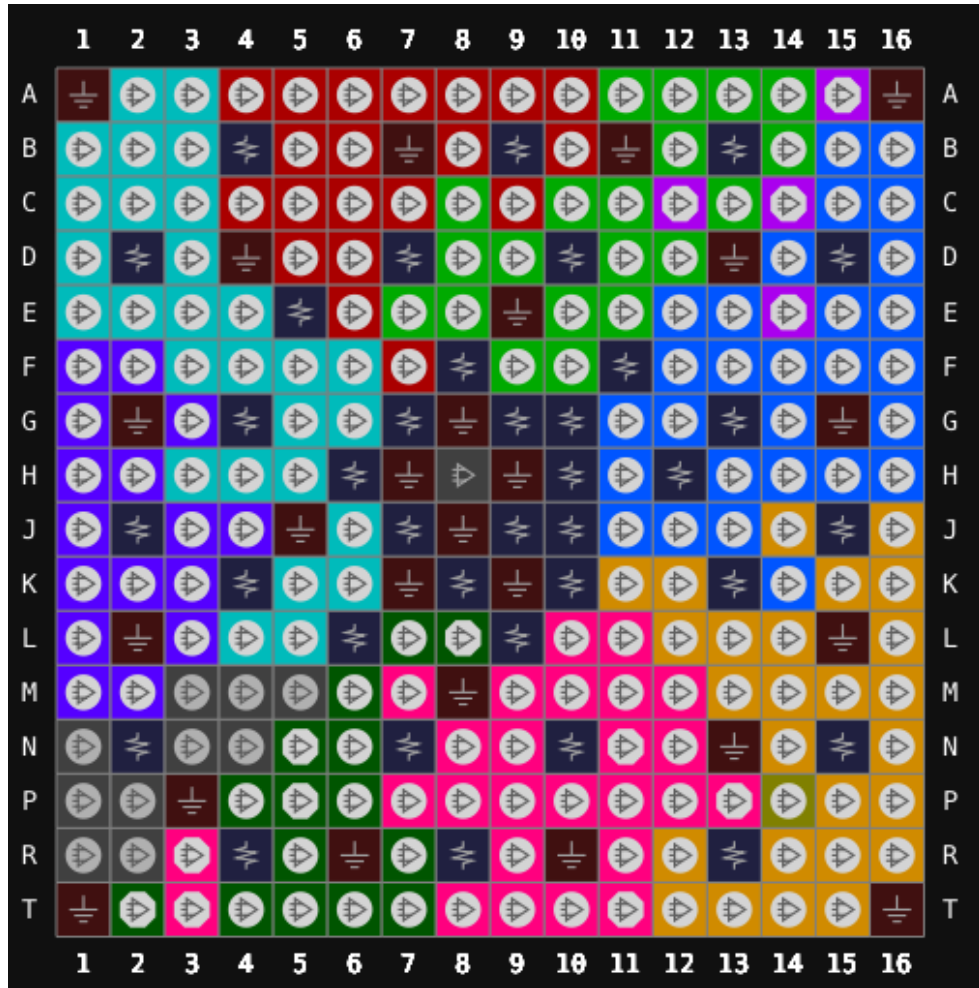
图 3-14 GW5A-25 器件 PG256 LV 版本封装管脚分布示意图（顶视图）
