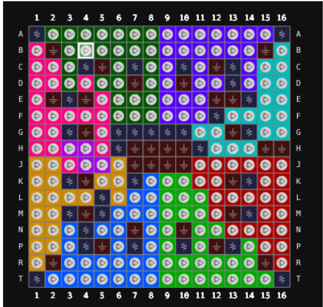
图 3-4 GW5A-25 器件 UG256C EV 版本封装管脚分布示意图（顶视图）
