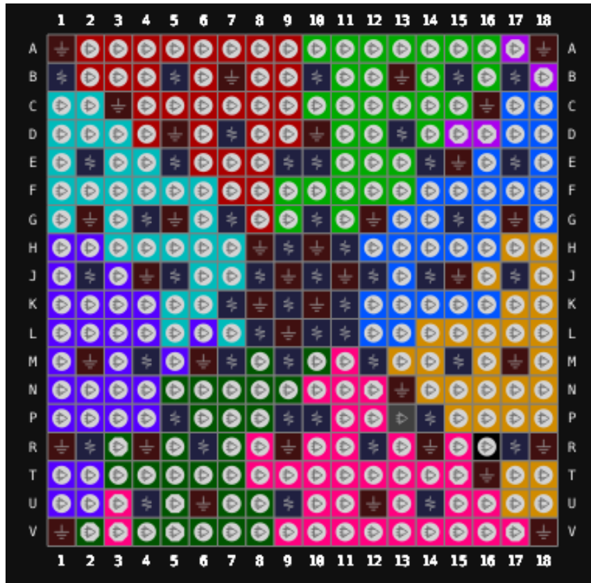
图 3-2 GW5A-25 器件 UG324S EV 版本封装管脚分布示意图（顶视图）
