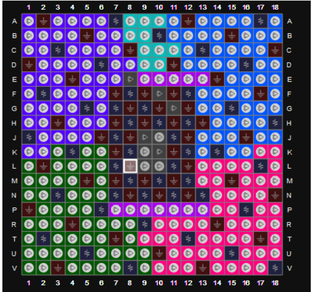
图 3-18 GW5A-138 器件 UG324A 封装管脚分布示意图（顶视图）
