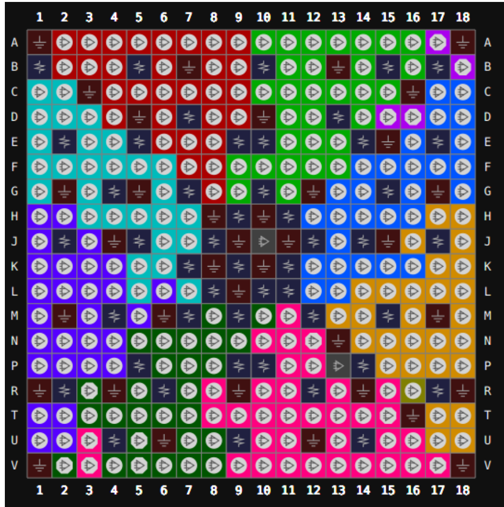
图 3-3 GW5A-25 器件 UG324S LV 版本封装管脚分布示意图（顶视图）
