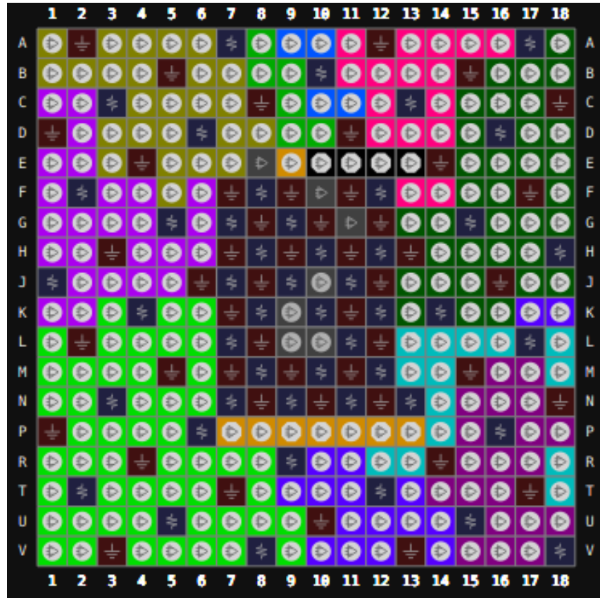
图 3-20 GW5A-60 器件 UG324A 封装管脚分布示意图（顶视图）
