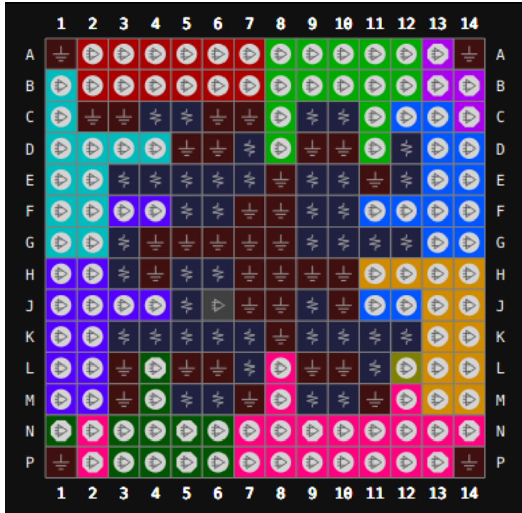
图 3-8 GW5A-25 器件 MG196S LV 版本封装管脚分布示意图（顶视图）
