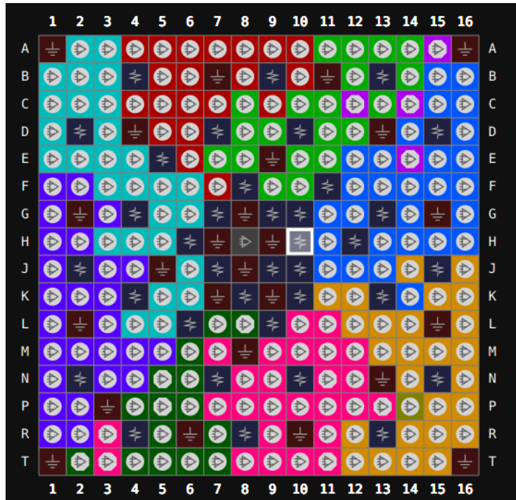
图 3-13 GW5A-25 器件 PG256S LV 版本封装管脚分布示意图（顶视图）
