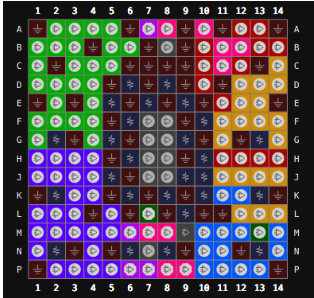
图 3-16 GW5A-25 器件 PG196S LV 版本封装管脚分布示意图（顶视图）
