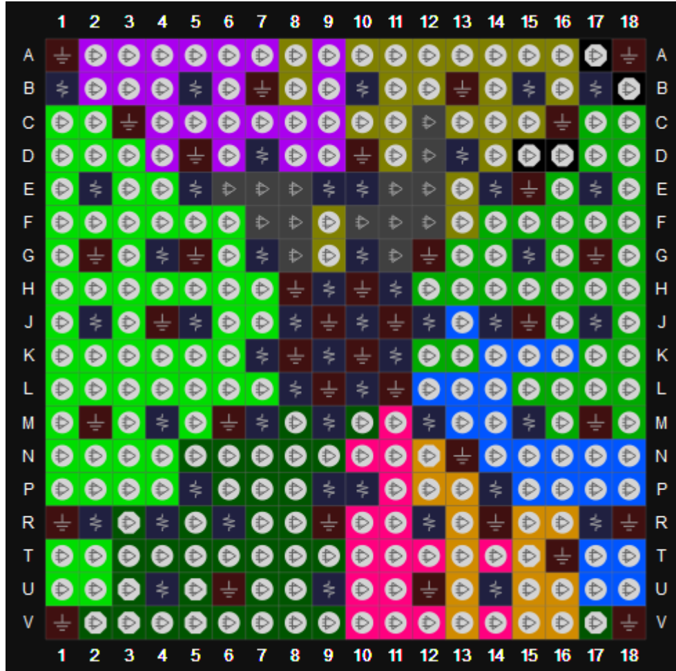
图 3-19 GW5A-60 器件 UG324S EV 版本封装管脚分布示意图（顶视图）
