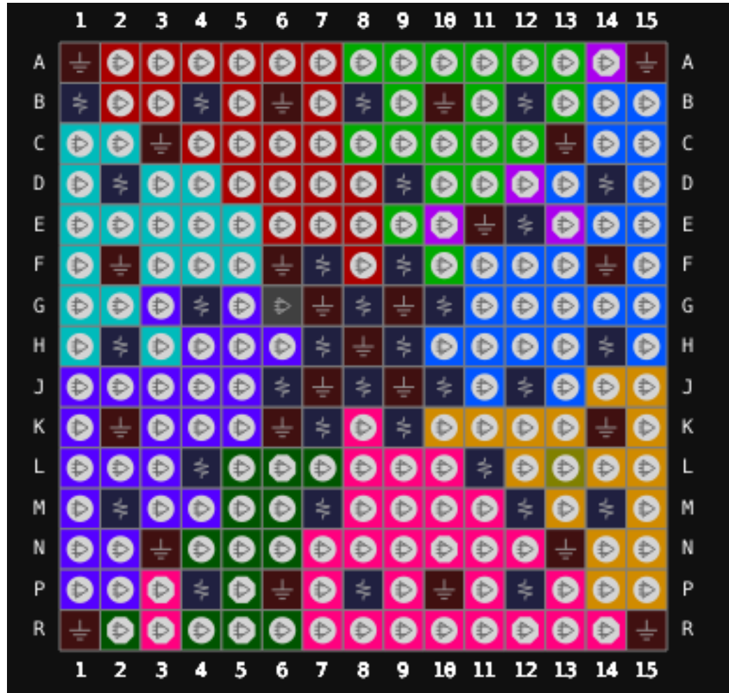
图 3-9 GW5A-25 器件 UG225S EV 版本封装管脚分布示意图（顶视图）
