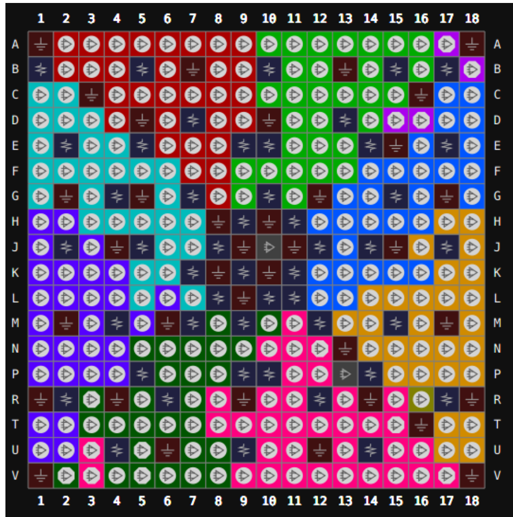
图 3-17 GW5A-25 器件 UG324S LV 版本封装管脚分布示意图（顶视图）
