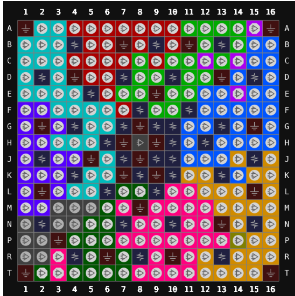
图 3-8 GW5A-25 器件 PG256 LV 版本封装管脚分布示意图（顶视图）
