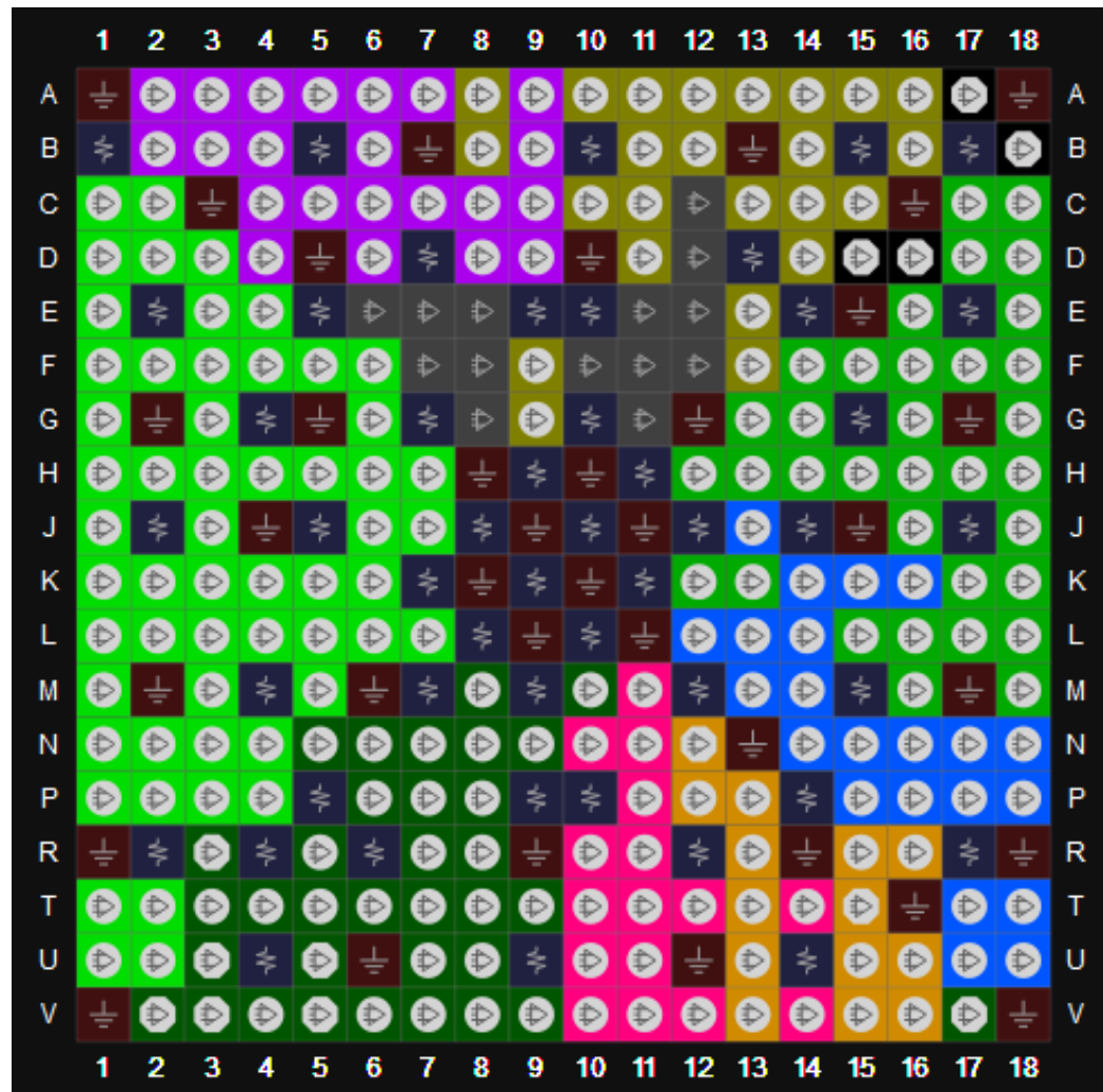
图 3-21 GW5A-60 器件 UG324S EV 版本封装管脚分布示意图（顶视图）
