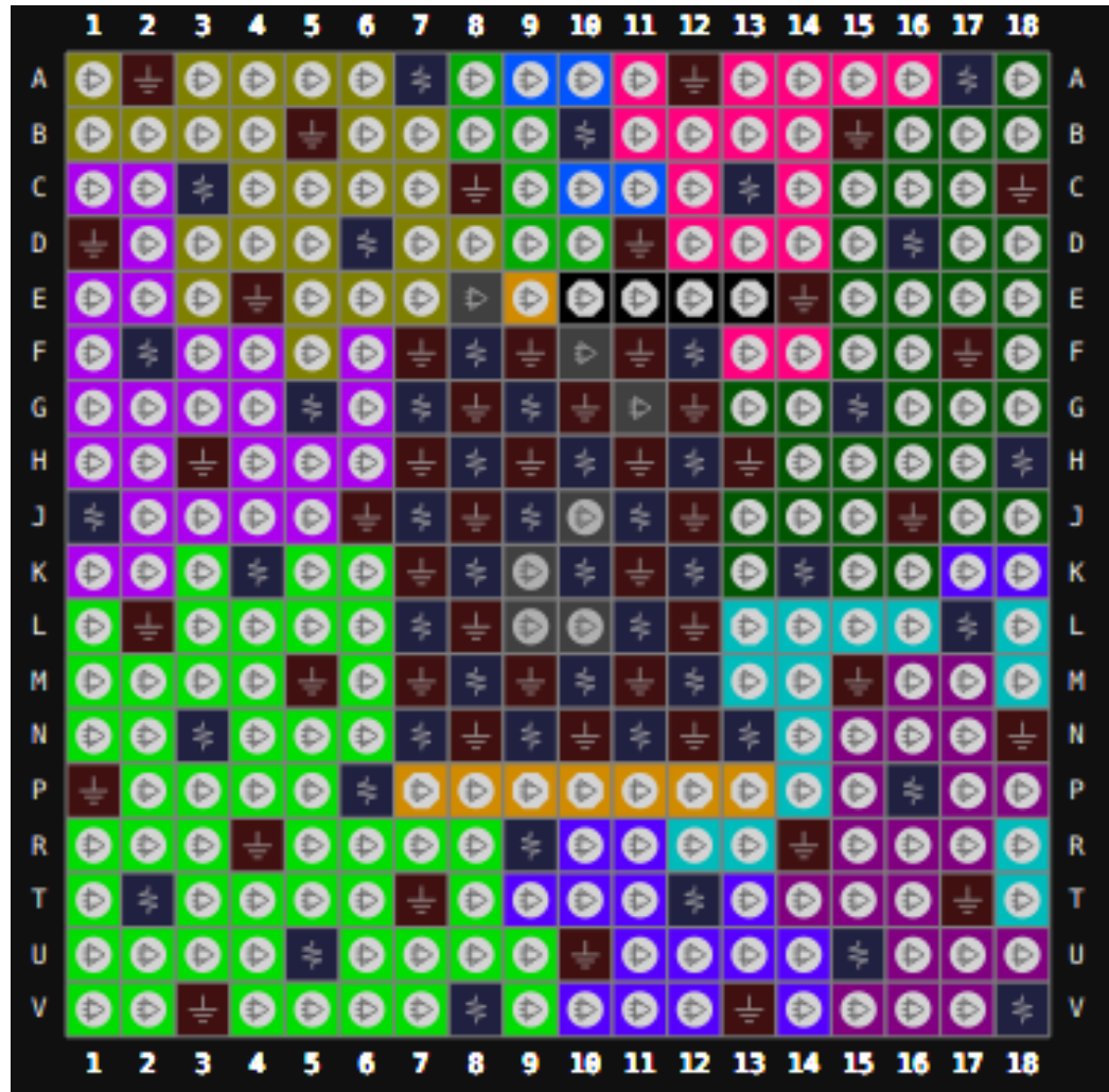
图 3-20 GW5A-60 器件 UG324A LV 版本封装管脚分布示意图（顶视图）
