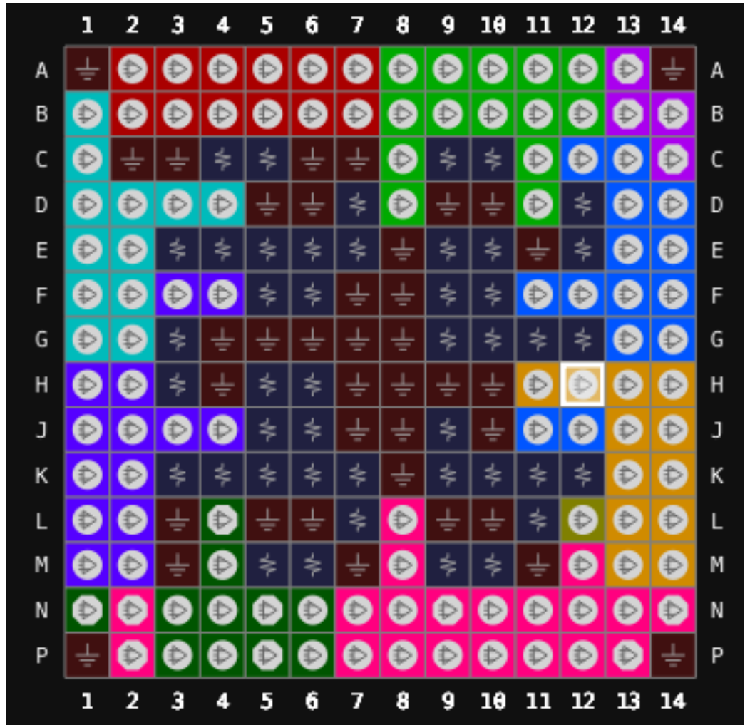
图 3-5 GW5A-25 器件 MG196S EV 版本封装管脚分布示意图（顶视图）
