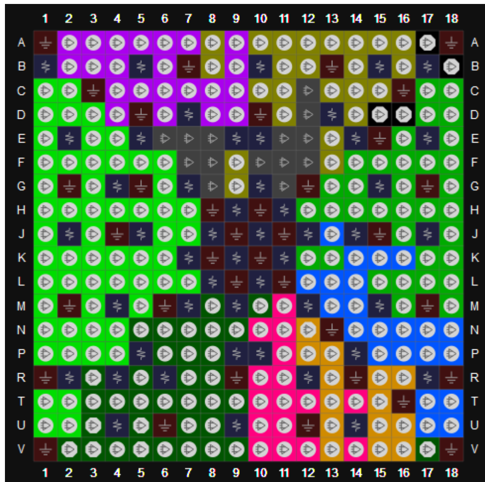
图 3-22 GW5A-60 器件 UG324S LV 版本封装管脚分布示意图（顶视图）
