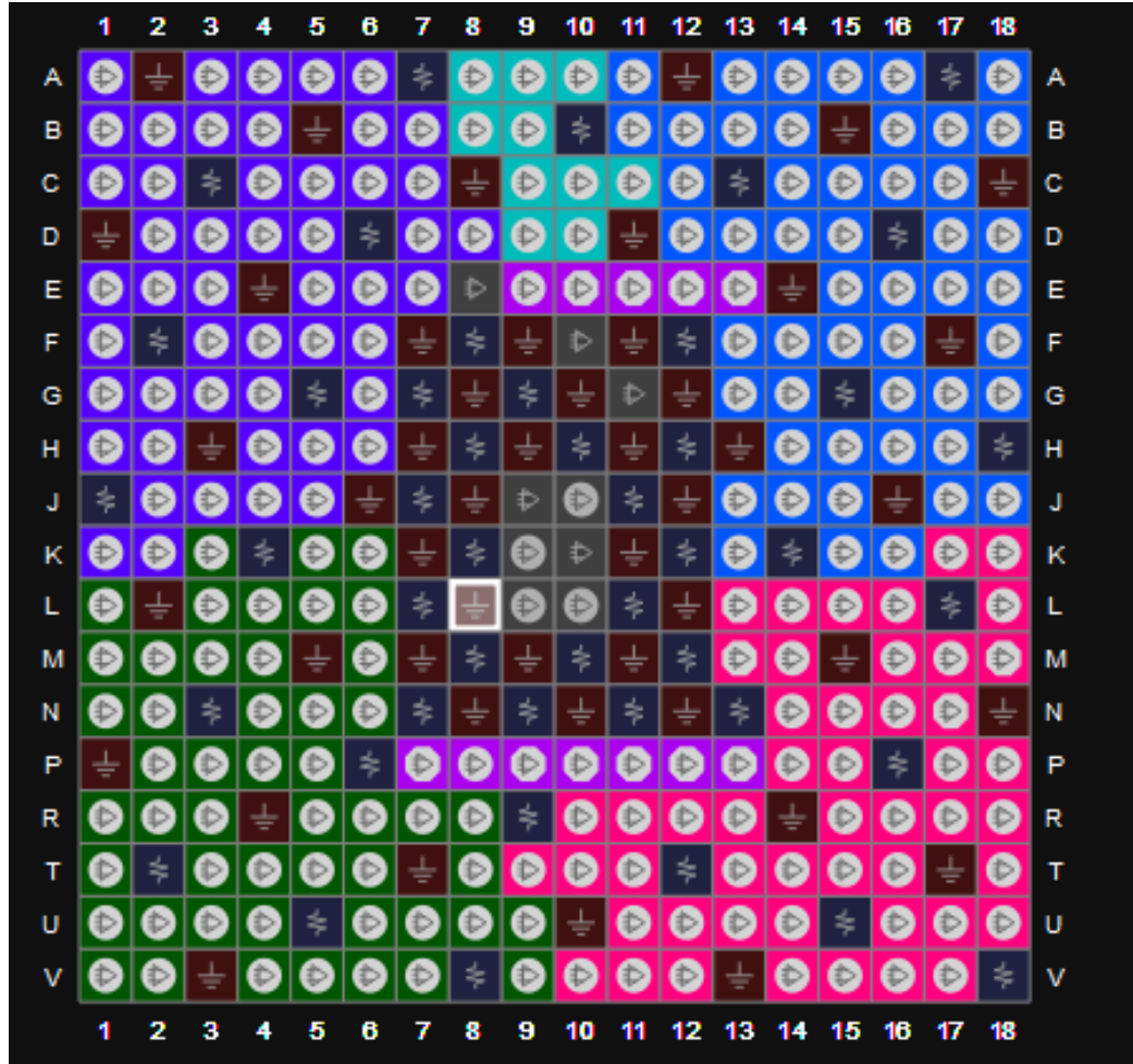
图 3-18 GW5A-138 器件 UG324A LV 版本封装管脚分布示意图（顶视图）
