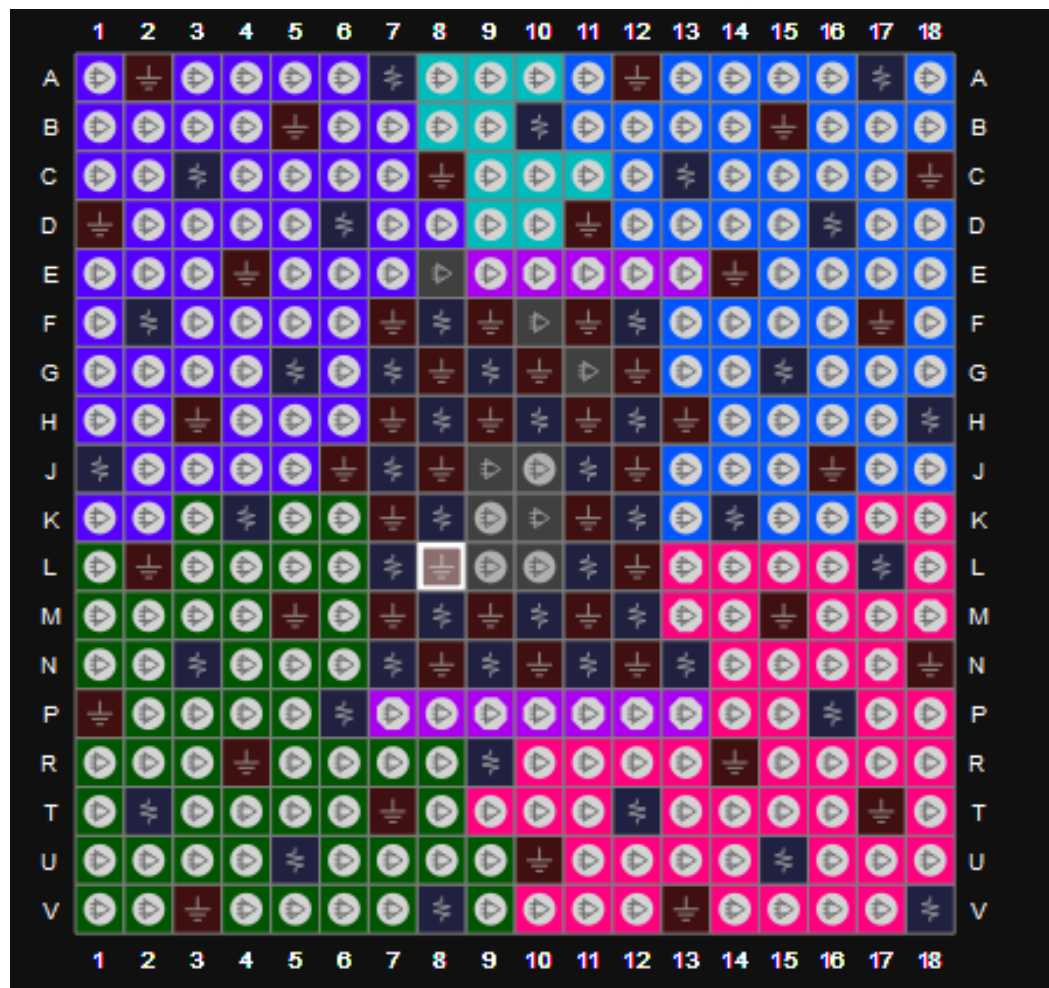
图 3-1 GW5AS-138 器件 UG324A 封装管脚分布示意图（顶视图）
