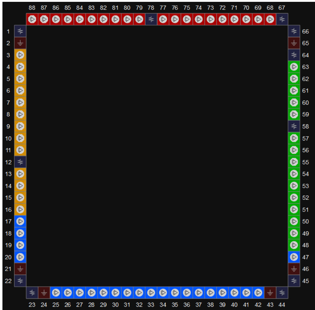
图 3-10 GW1NR-4 器件 QN88P 封装管脚分布示意图（顶视图，内嵌 PSRAM）
