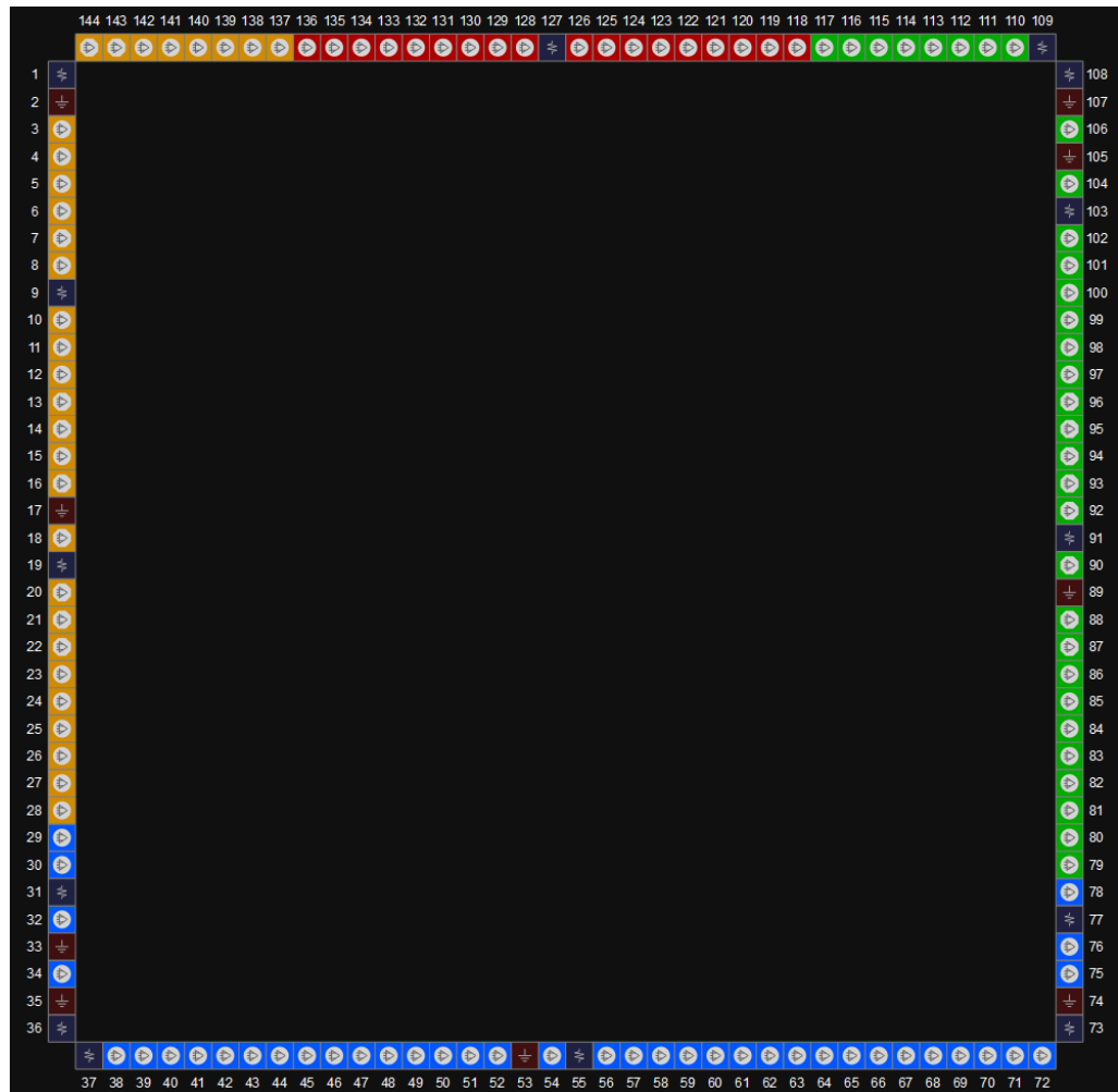
图 3-16 GW1NR-9 器件 LQ144P 封装管脚分布示意图（顶视图）
