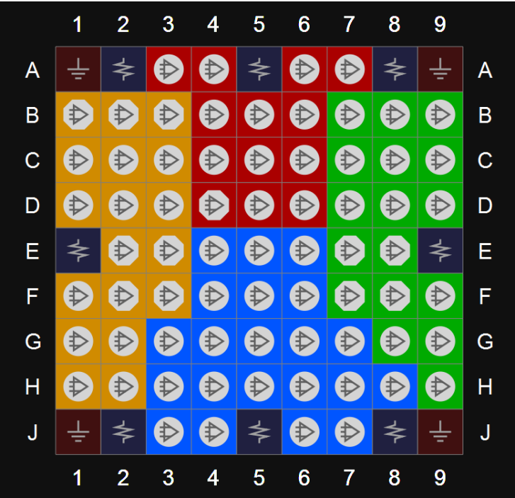
图 3-4 GW1NR-4 器件 MG81P 封装管脚分布示意图（顶视图，内嵌 PSRAM）
