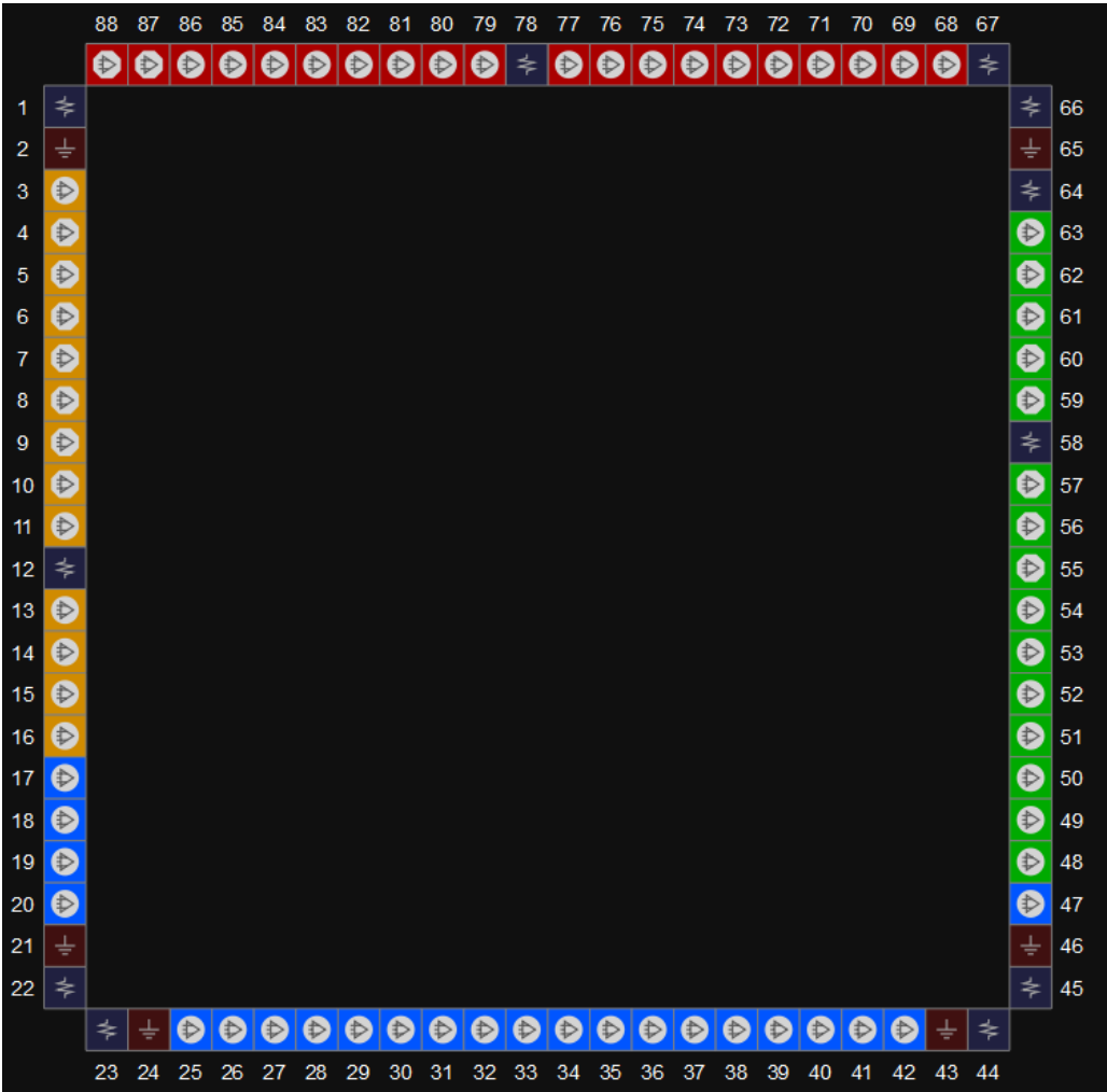
图 3-5 GW1NR-4 器件 QN88P 封装管脚分布示意图（顶视图，内嵌 PSRAM）
