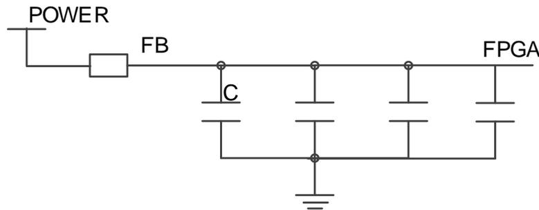
其中 FB 为磁珠，C 为陶瓷电容，精度不低于±10%。C 的电容值具体参考各封装最小系统原理图。
