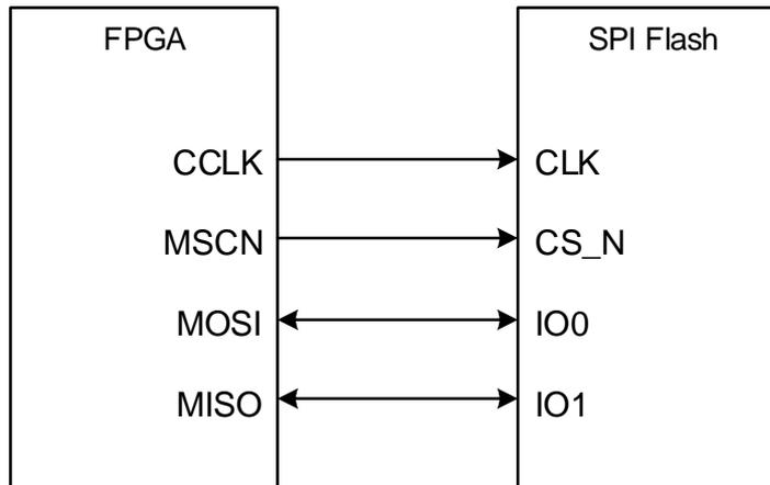
图 4-4 MSPIx4 配置模式连接示意图
