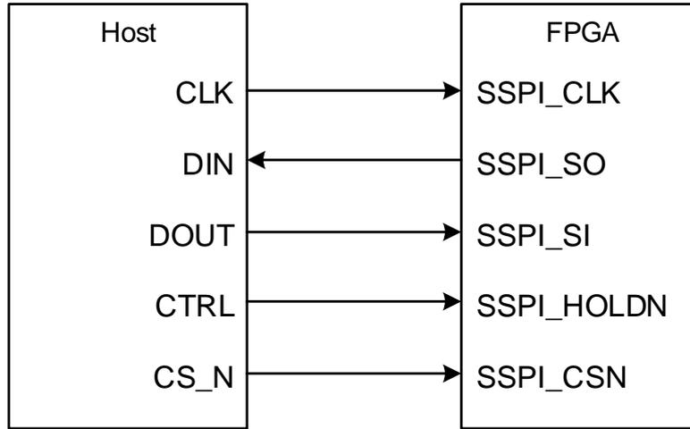
使用 SSPI 配置模式对多片 FPGA 产品配置的连接示意图如图 4-6 所示。
