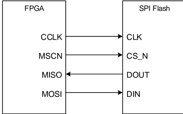
图 4-3 MSPIx2 配置模式连接示意图
