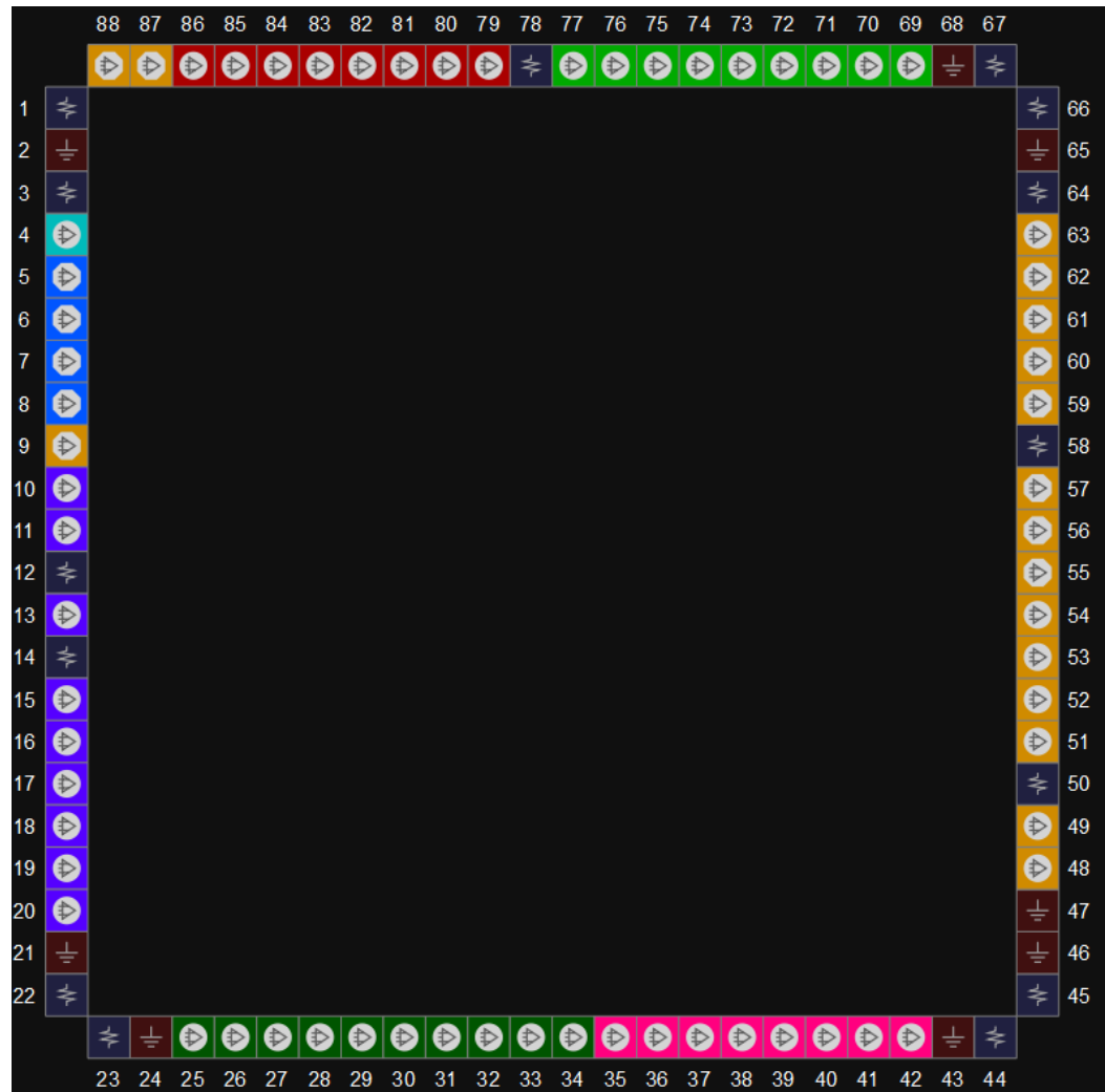
图 3-3 GW2AR-18 器件 QN88PF 封装管脚分布示意图(内嵌 PSRAM)
