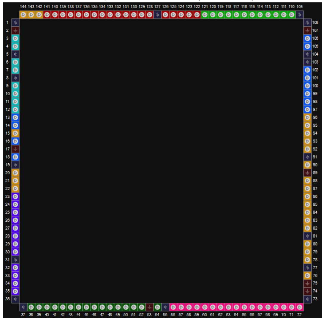
图 3-4 GW2AR-18 器件 EQ144 封装管脚分布示意图(内嵌 SDRAM)
