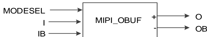
图 3-15 MIPI_OBUF 端口示意图
