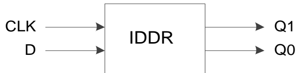
图 4-5 IDDR 端口示意图
