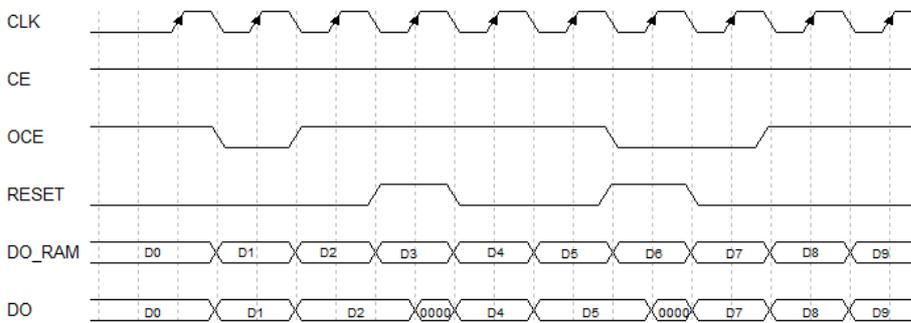
图 4-4 异步复位时序图（Pipeline 模式）
