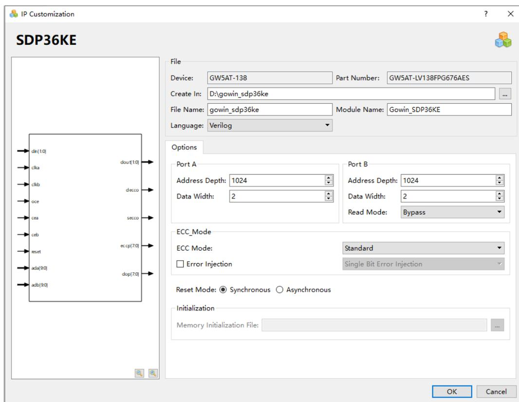
1. File 配置框。File 配置框用于配置产生的 IP 设计文件的相关信息。SDP36KE 的 File 配置框的使用和 BSRAM 双端口模式类似，具体请参考 6.1 BSRAM 双端口模式的 File 配置框。
