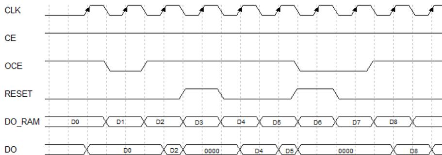
图 4-5 异步复位时序图（Bypass 输出模式）
