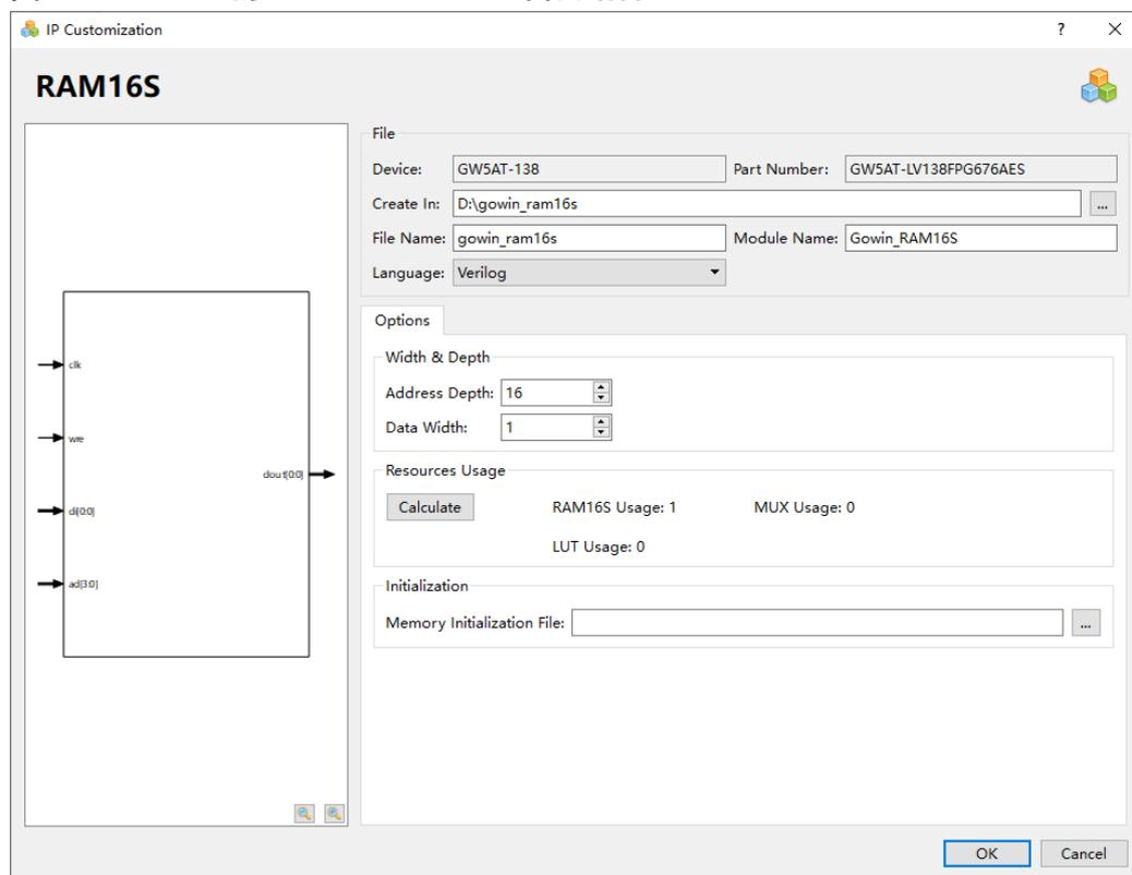
1. File 配置框。File 配置框用于配置产生的 IP 设计文件的相关信息。RAM16S 的 File 配置框的使用和 BSRAM 双端口模式类似，具体请参考 6.1 BSRAM 双端口模式的 File 配置框。
