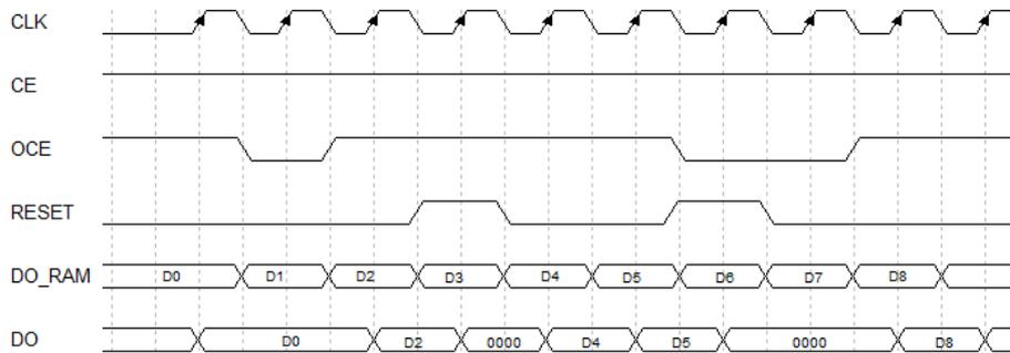
图 4-3 同步复位时序图（Bypass 输出模式）
