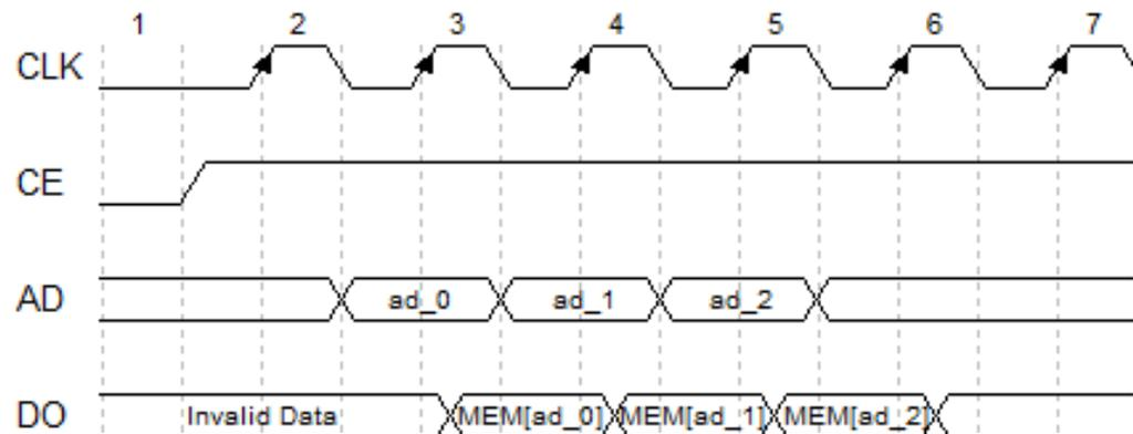
图 3-14 ROM 时序波形图 (Pipeline 模式)
