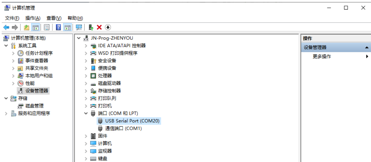
图 2-1 驱动安装完毕端口信息
