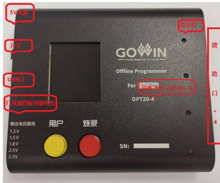
图 2-11 烧录器外观示意图
