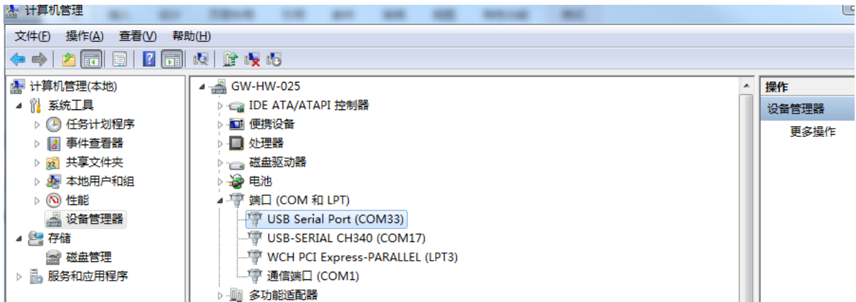
图 2-1 驱动安装完毕端口信息
