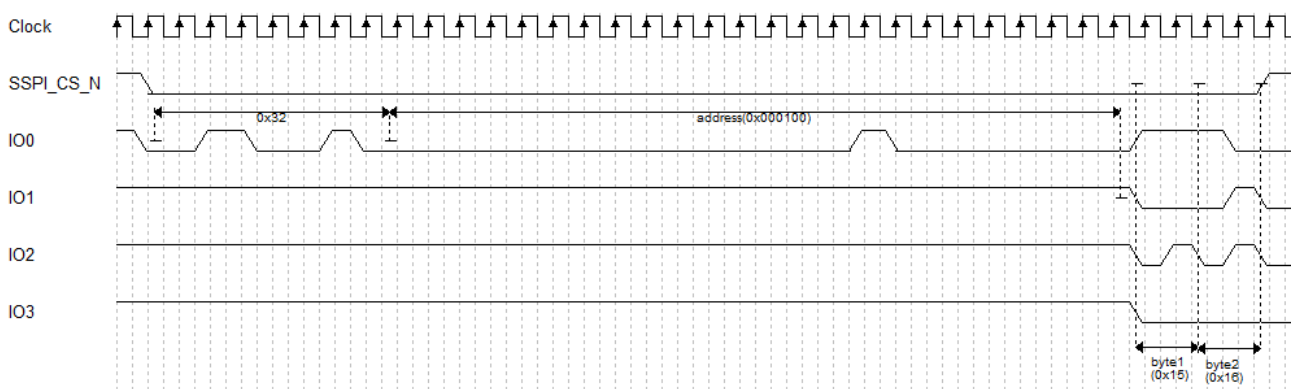
图 5-37 QSSPI page program 时序图
