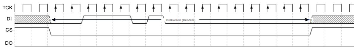
像上述两个指令，0x1500 和 0x3A00 指令的时序基本一致，指令都是在 CS 低电平后开始，并在指令传输完成后拉高 CS，遵循这种时序的指令有 0x3C00 (Reconfig/Reprogram)、0x1500 (Write Enable)、0x3A000 (Write Disable)、0x1600 (Program SPI Flash)、0x1200 (Init Address)、0x0500 (Erase SRAM)。
