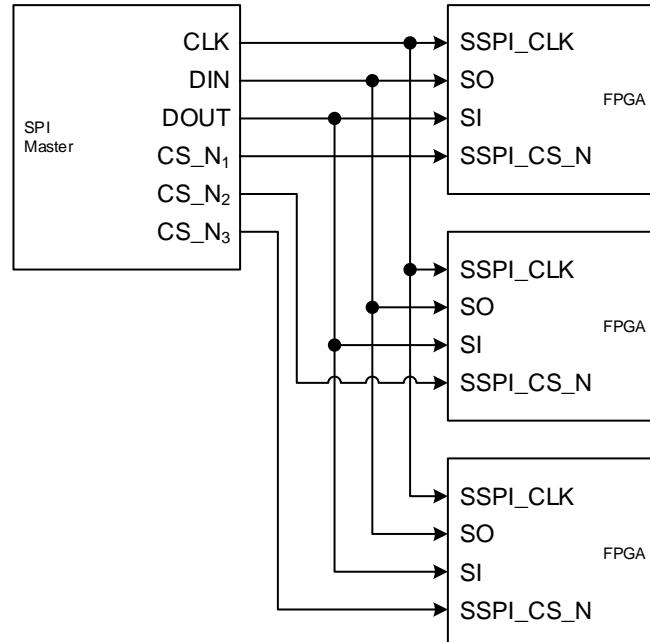
SSPI 配置管脚除了进行常规的 SRAM 配置操作外，还可编程 FPGA 外部的 SPI Flash，编程 Flash 操作的 MODE 值与 SSPI 配置模式的 MODE 值相同，用户可以在 Gowin 编程软件中选择将配置数据写入 SRAM 或外部 Flash。需要从外部 Flash 加载前，需要将 MODE 值调整为 MSPI
