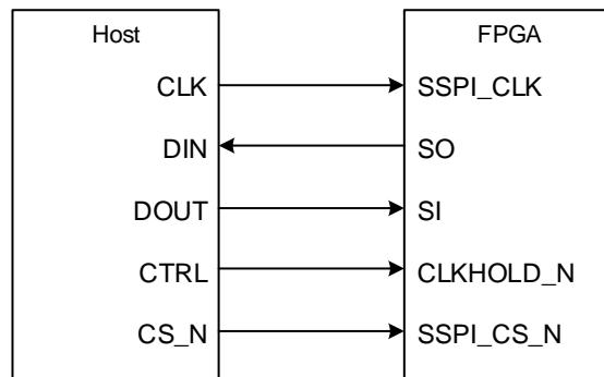
使用 SSPI 配置模式对多片 FPGA 产品配置的连接示意图如图 3-19 所示。
