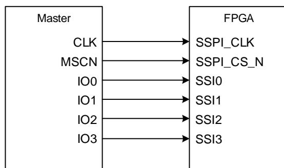
QSSPI Write Data (0x6B) 时序图如下图所示。
