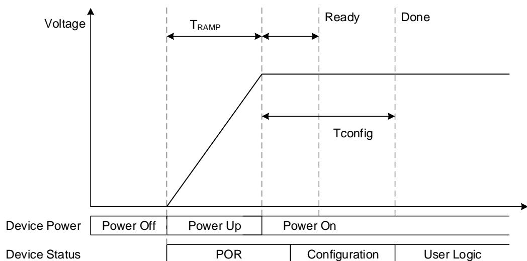
当 FPGA 的 VCC、VCCO、VCCX 供电电压满足最小供电幅值时，FPGA 进入启动流程：电压稳定且 RECONFIG\_N 未被外部电路拉低>FPGA 内部电路拉低 READY 和 DONE 管脚>FPGA 初始化>READY 拉高并采样 MODE 值>根据配置模式读取配置数据并校验>FPGA 唤醒>DONE 拉高>进入用户模式。
