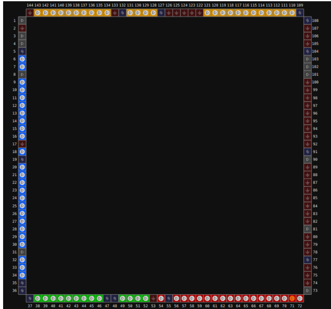
图 3-5 GW1NS-4 器件 LQ144 封装管脚分布示意图（顶视图）
