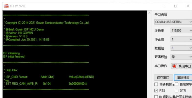
2. 指令控制，通过 UART 将指令格式发送给 FPGA 软核 Cortex-M1 进行相关控制。
