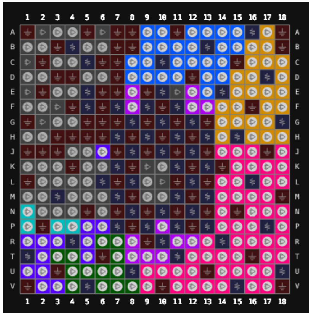
图 3-6 GW5AT-138 器件 UG324A 封装管脚分布示意图（顶视图）
