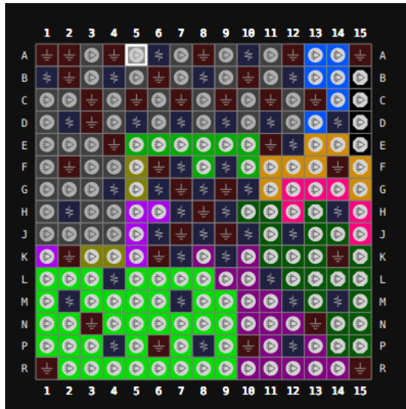
图 3-9 GW5AT-60 器件 UG225 封装管脚分布示意图（顶视图）
