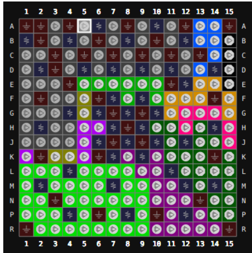
图 3-8 GW5AT-60 器件 UG225 封装管脚分布示意图（顶视图）
