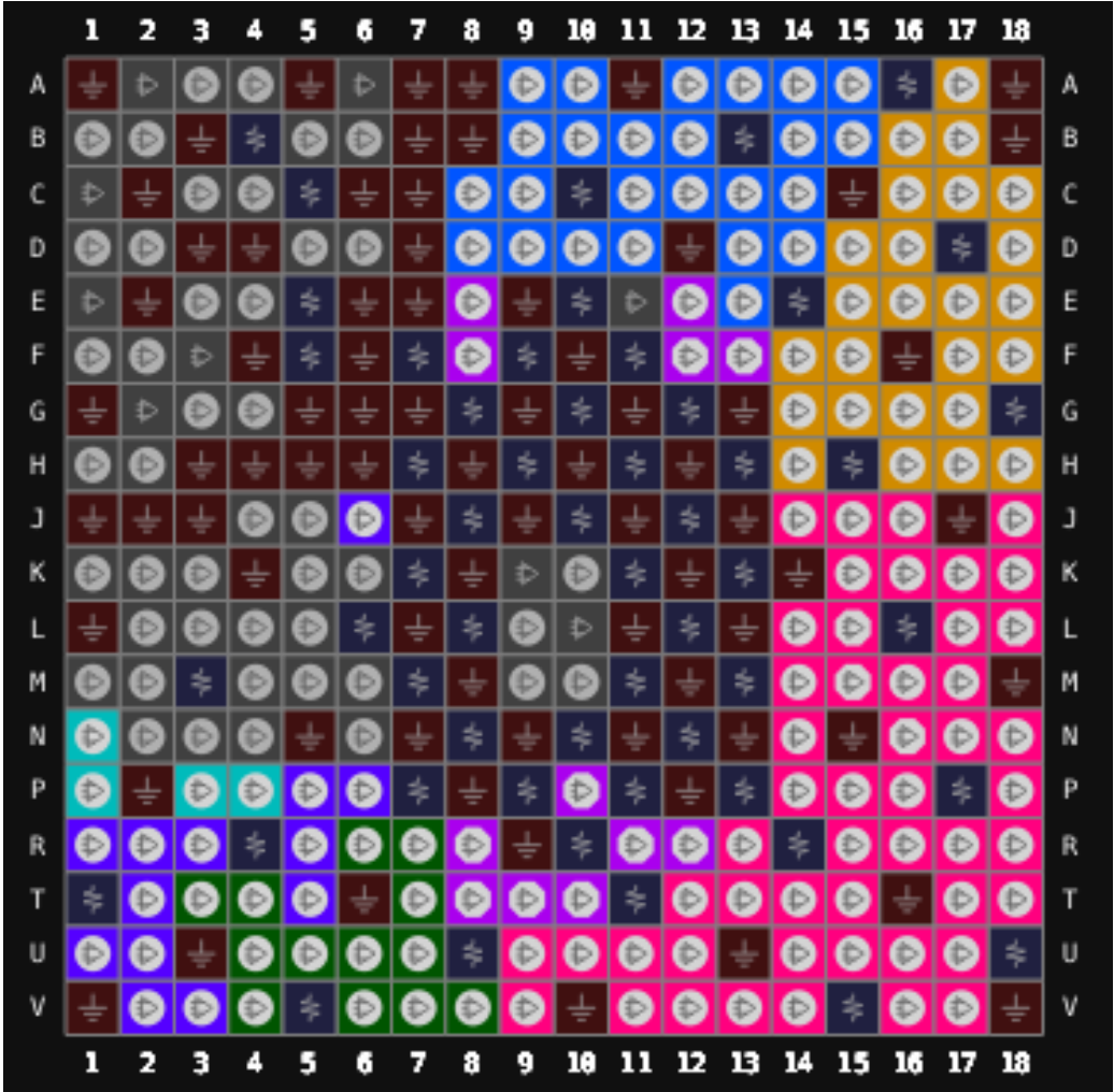
图 3-14 GW5AT-138 器件 UG324A 封装管脚分布示意图（顶视图）
