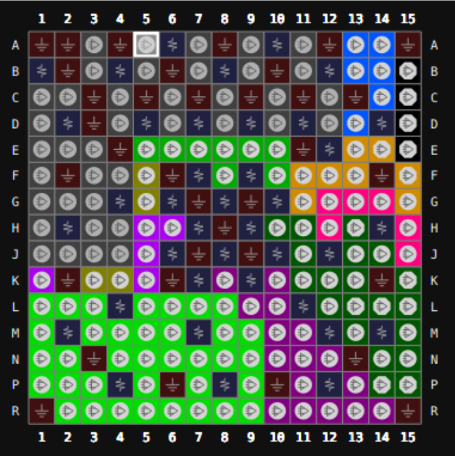
图 3-5 GW5AT-60 器件 UG225H 封装管脚分布示意图（顶视图）
