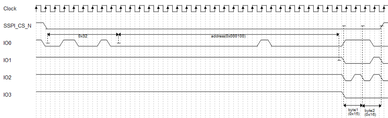
図 5-37 QSSPI page program のタイミング図
