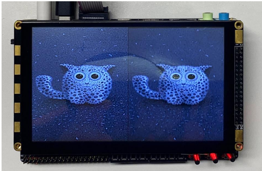
图 38-12 高斯滤波处理前（左）后（右）效果对比图（TFT）
