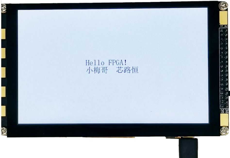
图 28-27 TFT 屏显示中文和英文混合字符效果图
