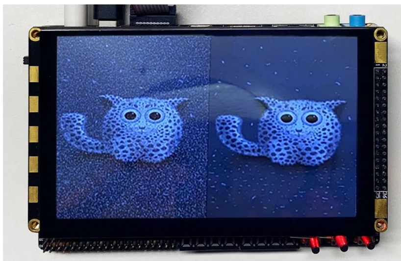
图 36-22 中值滤波处理前（左）后（右）效果对比图（TFT）
