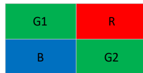
图 44-6 相邻四种颜色分量所代表的含义
