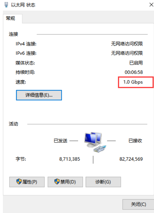
图 58-18 确保连接速度为千兆速率
