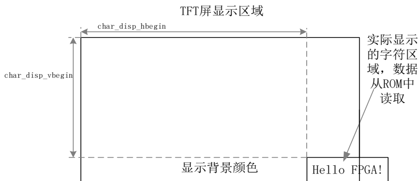
图 28-15 行起始和场起始相对于实际字符显示区域关系
