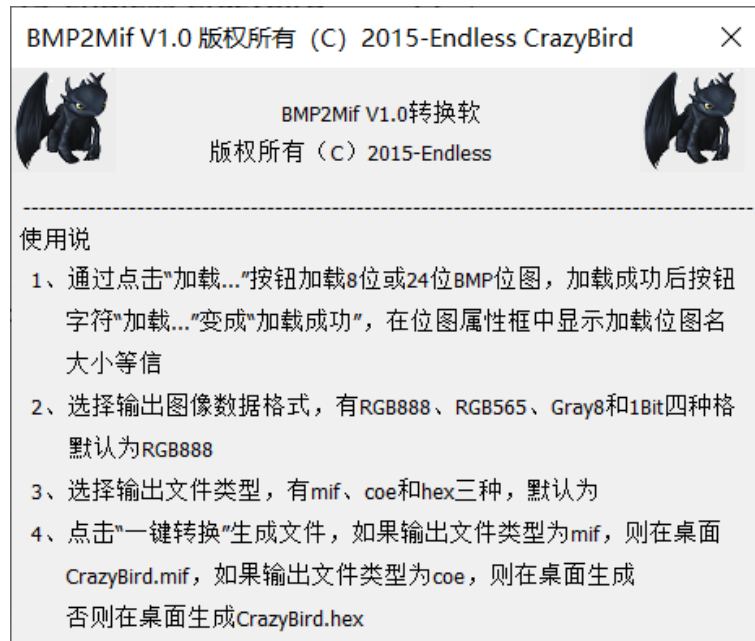
图 27-4 图片转换工具使用说明
