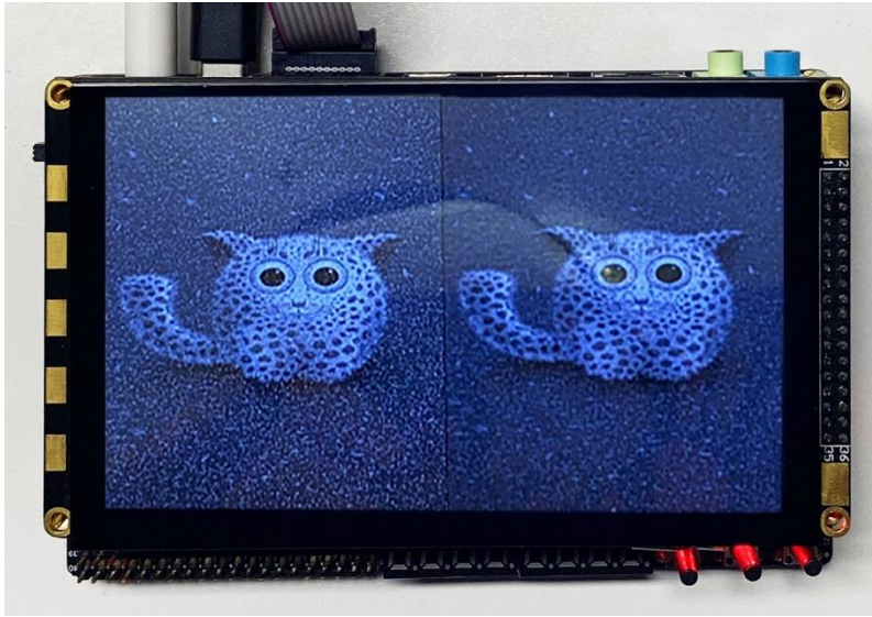
图 37-11 均值滤波处理前（左）后（右）效果对比图（TFT）
