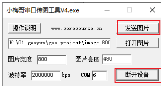
图 34-10 设置完图片信息后向对应的 com 端口号发送图片
