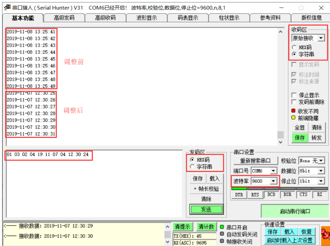
图 31-14 通过串口助手工具设置时间
