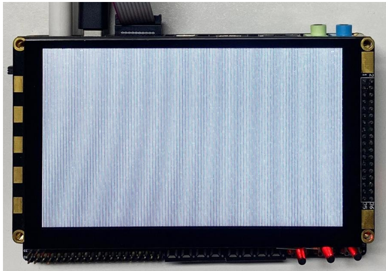
图 34-5 下载完程序后产生的碎花屏效果
