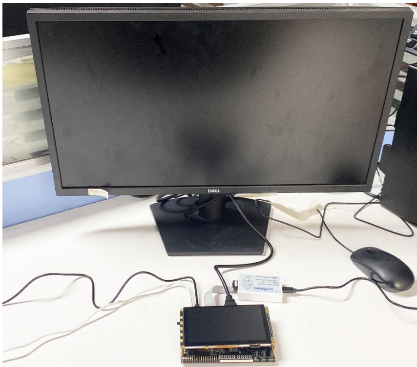
图 34-14 串口传图 HDMI 显示硬件搭建
