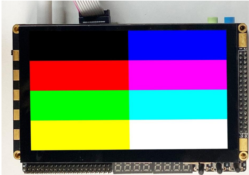
图 25-18TFT 屏幕驱动测试
