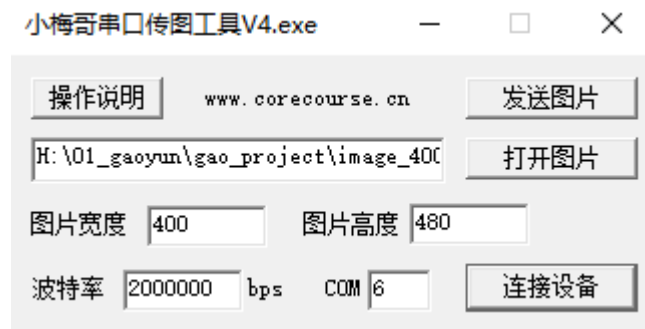
图 38-10 串口传图工具连接开发板
