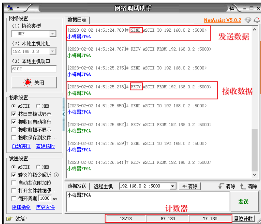
图 45-11 以太网回环测试
